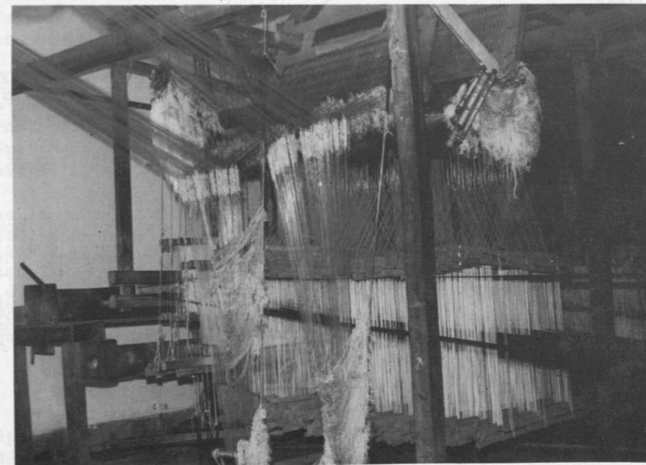
Fig. 6 - Métier à la tire de Fès, équipé de 360 baguettes-lisses actionnées par 2 tireurs agissant sur un semple (Fès, Atelier des Ben Chérif, 1975-1976).
