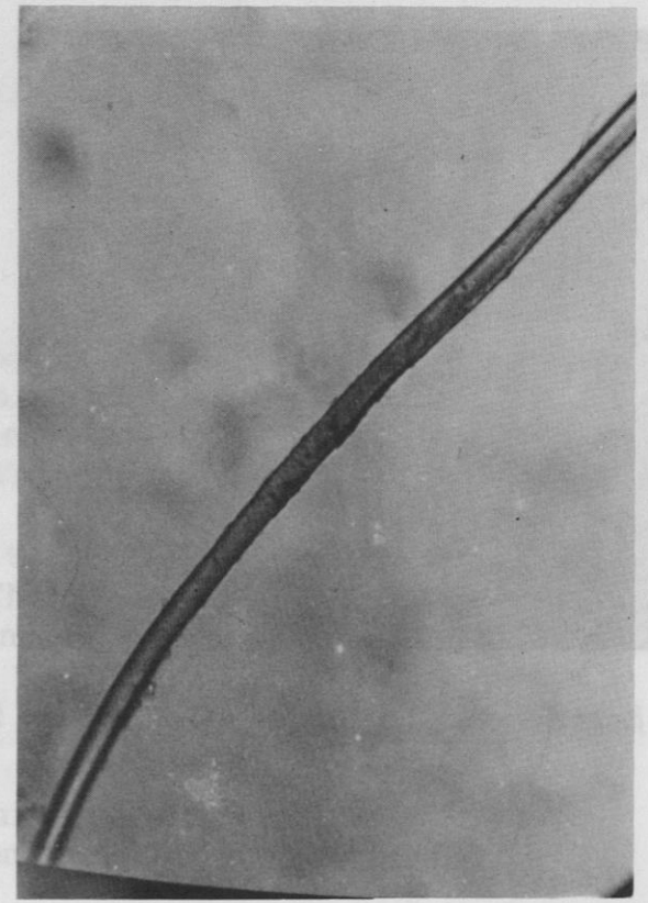
Fig. 10 - Microphotographie de fils extraits du tissu n° 746 (chaîne)
